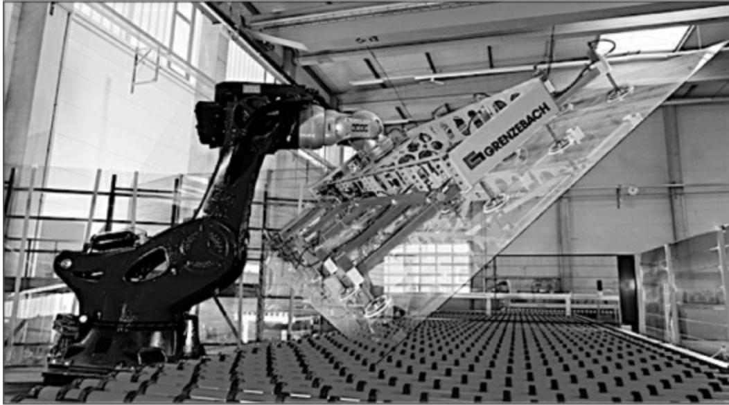
Figura 9.16. Manipulador para mover vidrios de gran tamaño.
